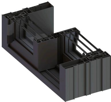
DOGMA GHOST è il primo sistema scorrevole in linea minimale della nuova famiglia DOGMA con profili ridotti. I "numeri" che lo caratterizzano sono: telaio da 200mm anta da 75mm portata da 250 Kg fino a oltre 750 Kg Uf del nodo base inferiore a 2,4W/mqK. DOGMA GHOST consente di realizzare le principali tipologie. Ferramenta di chiusura e movimentazione specifica per il sistema.
